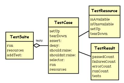
**Figure 2** Les quatre classes définissant le noyau de SUnit avec leu principales méthodes.
